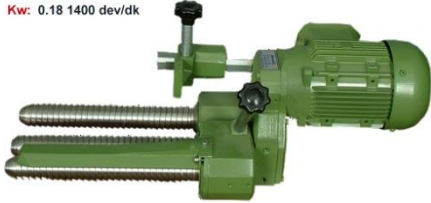
Üç parmak ram kenar açıcı Kw: 0.18 1400 dev/dk
